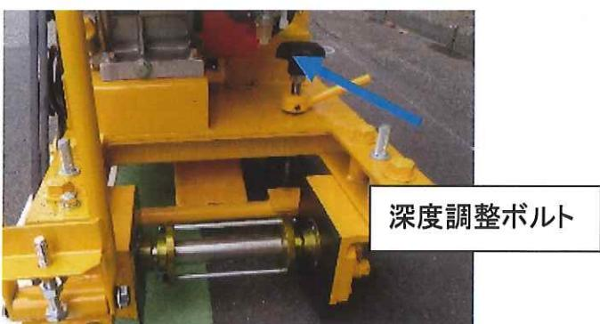
16 切断深度を固定したら、前後進レバーを少しずつ上方向にあげると機械本体が前に進みます。
