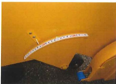
切断震度計は深度を確認する目安として使用して下さい。
