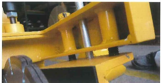
12. M14 ボルト 2 本を交互に軽く締めながらブレードシャフトを回し、ピローやブレード取り付けなどに異常が無いかを確認しながら M14 ボルト 2 本を交互に締め付け固定し、最後にブレード締め付けナット(M6 左ネジ)-H10 を締め付けて下さい。
