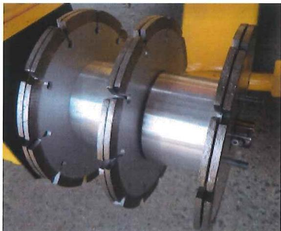
10. 一体型(ブレードフランジシャフトS・ピローブラケット)を取り付けブレード締め付けナット(M6 左ネジ)
