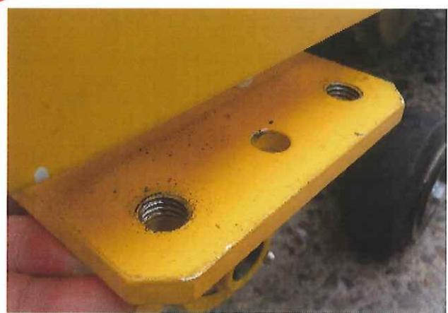
6. ブレード締め付けナット(M6 左ネジ)-H10を外す。
