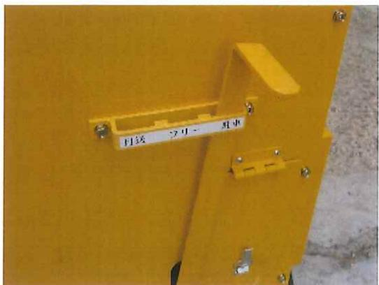
2. 機械を上昇させ、機材本体が降下しないように昇降装置ロックを掛ける。
