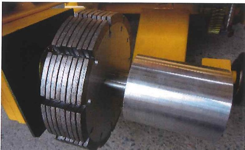
4. ブレードフランジシャフト S を付けブレード締め付けナット(M6 左ネジ)-H10 を仮締めする。
