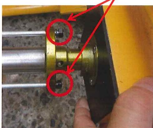
※ブレード締め付けナットは左ネジ(逆ネジ)です。
