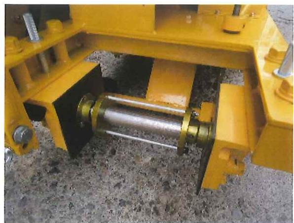
5. ピローブラケット取り付けボルト(M14)-H22とポジションピンを外す。
